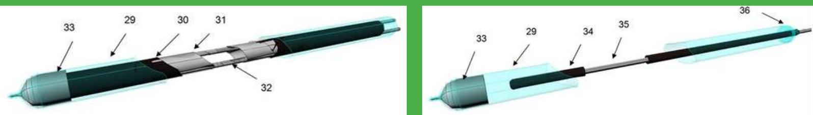
*Fig.10 Struttura di due differenti tipologie di tubi assorbitori dewar. Quello superiore integralmente in vetro e quello inferiore con un passante vetro metallo*
