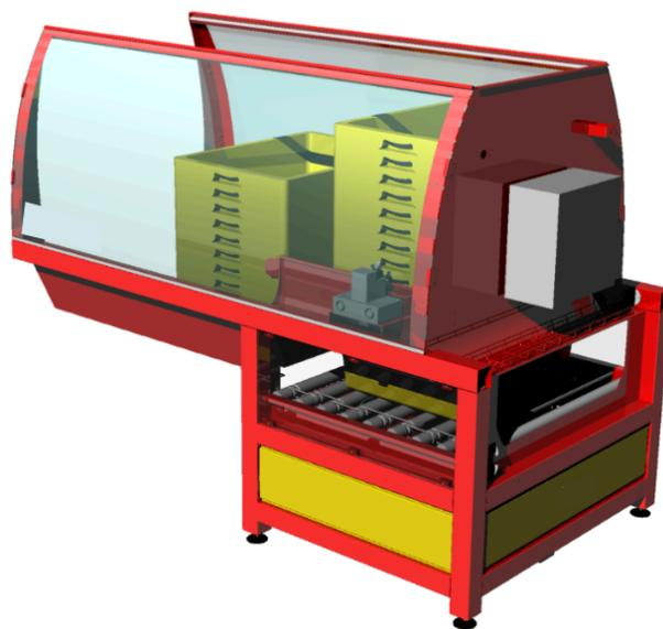
**Fig. 9** -Impilatore lato carico vassoi.
